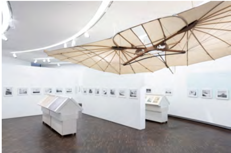
Originalgetreuer Nachbau des Normalsegelapparats von Otto Lilienthal. Er entspricht in Aufbau, Material, Verarbeitung und Form dem Original. Spannweite: 670cm, Länge: 550 cm. Otto Lilienthal-Museum, Anklam (Foto: F. Jesse).
